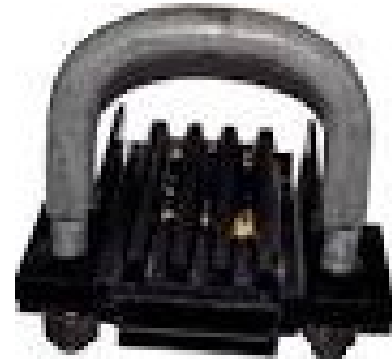
Şəkil 1.12. Kanatları sıxmaq üçün xüsusi açar ("struptsina")
